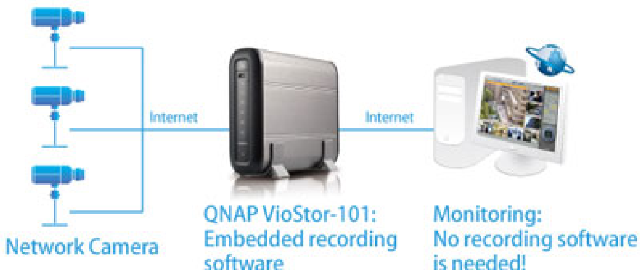
Rys.56 Schemat odbioru on-line obrazu z kamer monitorujących na komputerze, przez sieć internet.
